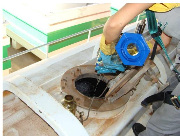
**Figuras 20/21 - Coleta de amostra corrida com saca-amostra e lavagem de proveta**
