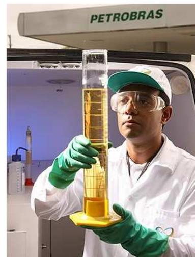
**Figuras 15/16 - Procedimento 1: a amostra deverá ser agitada e avaliada em relação à presença de material particulado ou gotas d'água abaixo do vórtice.**
