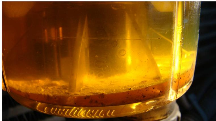
**Figuras 28 - Amostra reprovada: presença água livre e material particulado**
