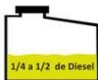
**2** Aplicar o tratamento A550 na dosagem 0,5% da capacidade total do tanque. Exemplo: Tanque de 200 litros, aplicar 1 litro do tratamento.
